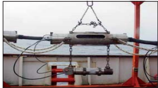
Foto 2. Armado del Air Gun, en este caso un modelo Long Life Air Gun (Extraído de: Ecologistas en acción, 2005).
